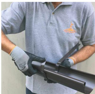
Il sostegno della grondaia MONTAFACILE è prodotto in piatto zincato a caldo e verniciato a polvere. È quindi di elevata qualità ed è in grado di sostenere la grondaia in qualunque situazione e per molti anni. La grondaia viene saldamente bloccata nel sostegno con il semplice ripiegamento manuale di due linguette metalliche.
