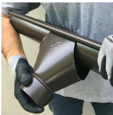
La bocchetta di scarico è esterna ( tipo " tramoggia " ) e si assembla ad incastro con un veloce movimento, senza necessità di utensili, di viti o rivetti e se vuoi correggere la posizione....la puoi sganciare e spostare senza problemi.
